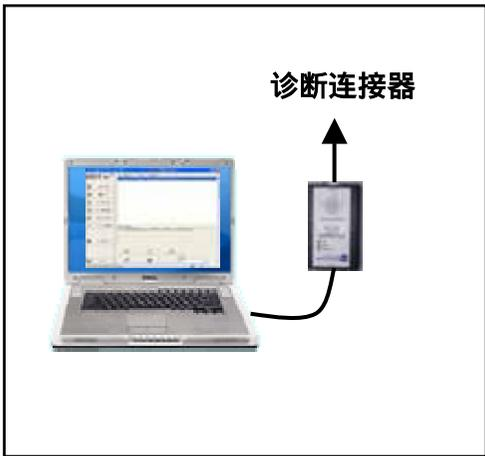
1. 将IG SW置于「ON」，确认诊断代码。
