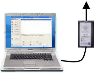
1. 把IG SW做为「ON」、检查维修代码 有无输出维修代码
