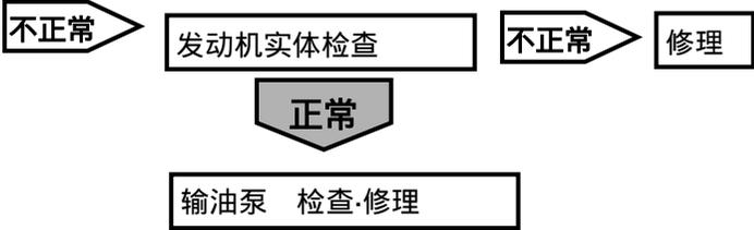
8 高压燃油管、喷油器/输油泵/共轨 是否有燃油泄漏（发动机外部泄漏）
