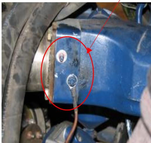
2、线束在整车上进行布置时，要做好足够的保护措施，防止线束在车辆长期运行过程中造成磨损现象，导致短路等情况的发生。
